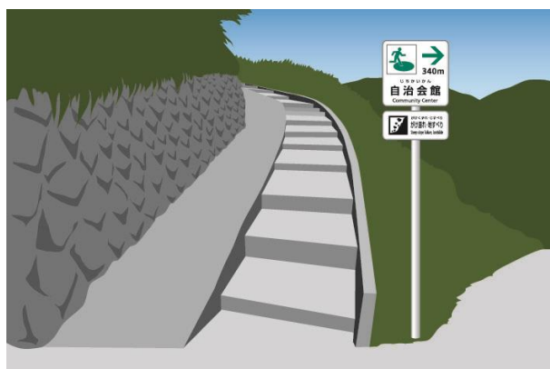
d) 分かれ道の地点にポール式の崖崩れ・地滑り避難誘導標識を設置した例。
