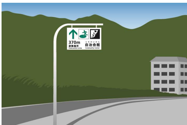
e) 道路脇にポール式の崖崩れ・地滑り避難誘導標識を設置した例(遠くからでも視認できる)。
