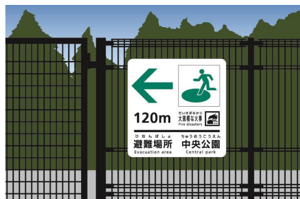
e) フェンスに大規模な火事避難誘導標識を設置した例。
