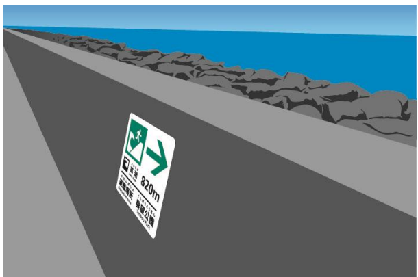
e) 堤防の陸側に高潮避難誘導標識を設置した例。
