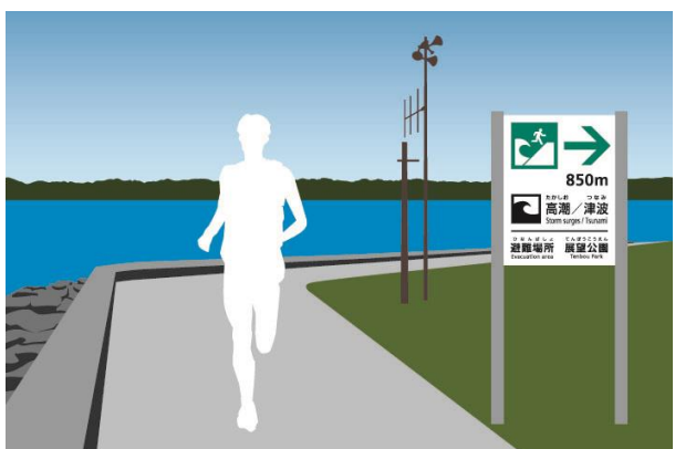
c) 海岸近くの遊歩道に自立式の高潮避難誘導標識を設置した例。
