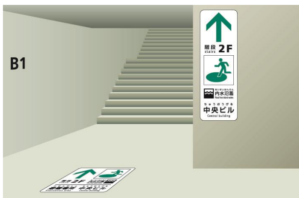
e) 地下の壁面及び床面に内水氾濫避難誘導標識を設置した例（屋内避難案内の場合）。
