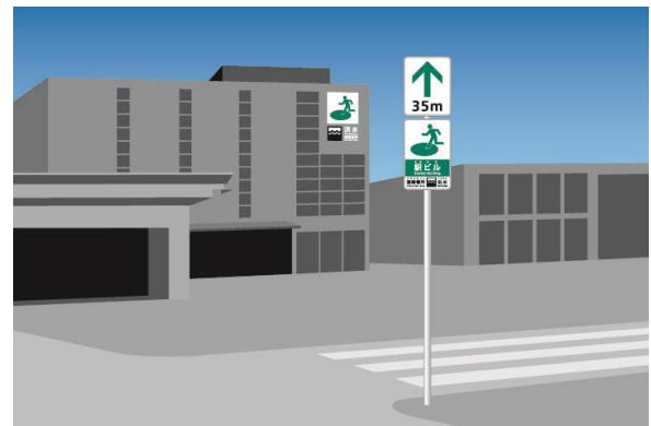
d) 建物の上部及びポール式の洪水避難誘導標識を設置した例。
