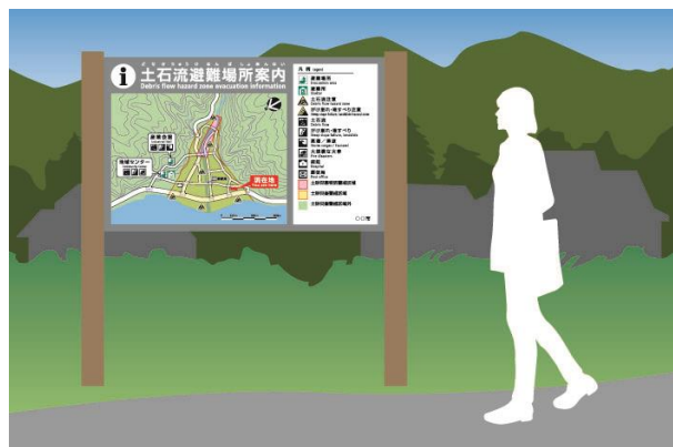
b) 目につきやすい場所に自立式の土石流避難情報標識を設置した例。
