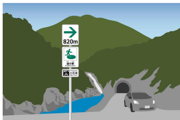
d) 山及び川に挟まれた付近にポール式の土石流避難誘導標識（補助標識タイプ）を設置した例。
